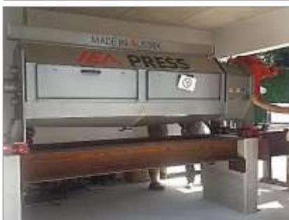
La pressa a vite proposta è formata da una coclea a vite con albero, che scorre all'interno di una sorta di condotto realizzato da un'alternanza di dischi fissi e dischi mobili.
