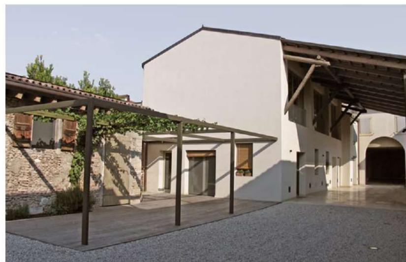
INTONACO CON FINITURA SUPERFICIALE TIPO INTONACO A CALCE
