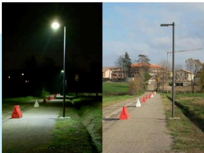
il flusso luminoso viene attenuato durante le ore di minor traffico, in un'ottica smart city. Il tutto nel rispetto della normativa regionale sull'inquinamento luminoso finalizzata a garantire un maggior illuminamento sulle strade con un minor consumo di energia.
